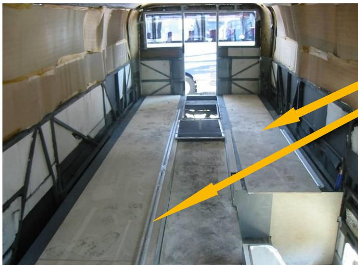
床面部材やシートの取付レールの取り換え、並びに内装を新しくする作業
