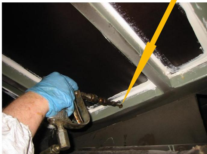
枠組み構成部材及び車体下部の防錆処理を行っているところ
