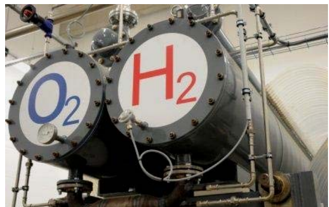
Wasserstofferzeugung aus erneuerbaren Energien mit Elektrolyseuren. (Quelle: Enertrag)
