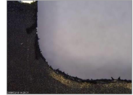
《Lithium-ion electrode, t = 0.12mm》
