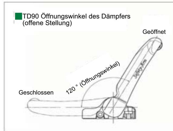
Die obige Abbildung zeigt den Öffnungswinkel der Serie TD90B1. Die Achsstellung bei Lieferung ist die Stellung in geöffnetem Zustand.
