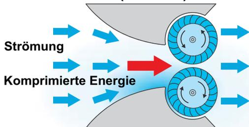
Mittels des Aufbaus mit 2-Achs-Vertikalturbinen wirkt die Energie des Wasserdurchflusses direkt auf die Turbinen und wird in effizienter Weise zur Stromerzeugung genutzt.
