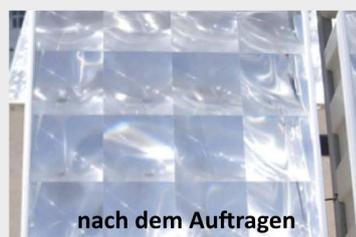
Das Foto zeigt sehr deutlich die Wirkung bei einem Panel in der Wüste außerhalb Saians, China, 3 Monate nach der Aufbringung der Beschichtung. Das nicht beschichtete Glas hat eine um 10% verringerte Energieeffizienz. Produkte anderer Firmen zeigen bei Verschmutzung durch Staub und Sand kaum einen Effekt.
